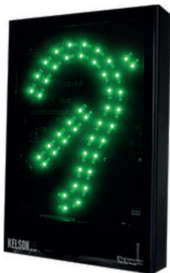
Pictogramme Preventex Pictogramme tricolore réactif à l'intensité du bruit
